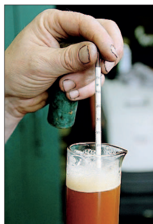
Le densimètre mesure la densité de sucre dans le jus.
